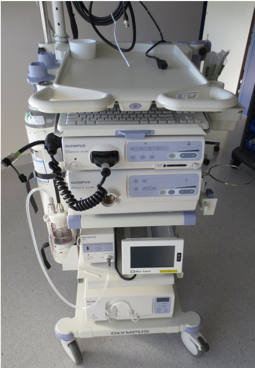
Abbildung 5: Nachrüstung Gerätewagen durch DICOM-Bildwandler
